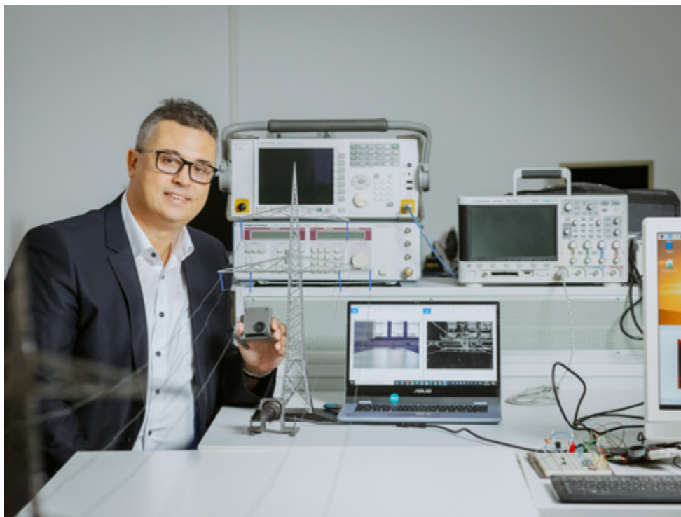
Prof. Faouzi Derbel zeigt, wie die Messeinrichtung mittels intelligenter Bildverarbeitung den maximalen Durchhang von Stromleitungen erkennen soll
